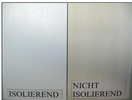
Obr. 2.6: Porovnanie izolačného účinku povrchovej úpravy s izolačným plničom a bez neho
